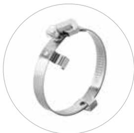
Mit diesem Clip kann die TORRO® auf dem Schlauch vorpositioniert werden. Die 'Zähne' der Clips halten die TORRO® Schlauchschelle sicher am Platz, wenn sie vor der Endmontage gelagert oder transportiert werden muss. Für die TORRO® in der Bandbreite 12 mm erhältlich.
