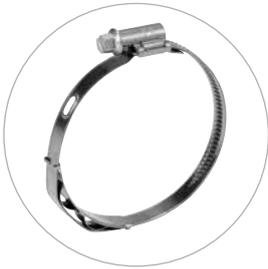
Die Aussparung ist ein cleveres Mittel, die TORRO® Schlauchschelle auf dem Schlauch vorzupositionieren. In diesem Fall findet die ovale Aussparung im Schellenband ihr direktes Gegenstück auf der Schlauchoberfläche. Dies sorgt für einen sicheren und exakten Halt der TORRO® vor der Endmontage. Auf Anfrage in den Bandbreiten 9 und 12 mm und mit verschiedenen Winkeln lieferbar.
