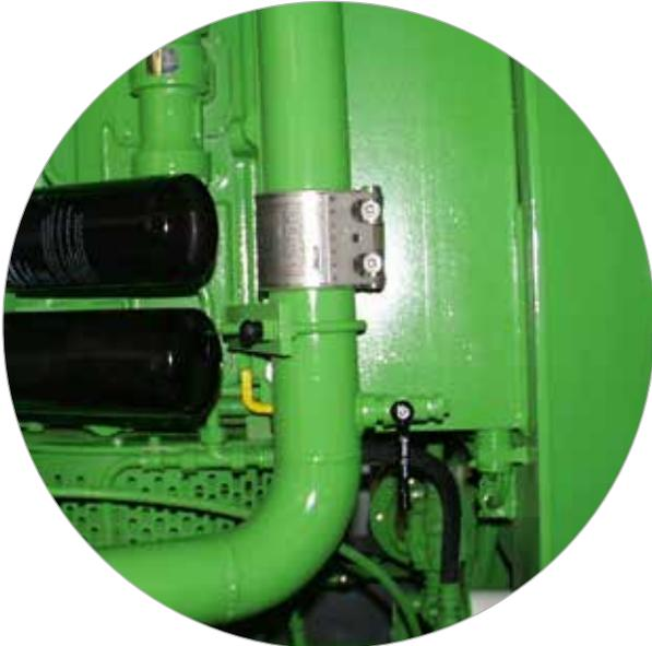
FGR-Rohrkupplungen sind ein kompaktes, wirtschaftliches und zuverlässiges Mittel zur Verbindung glattendiger Rohre. Mit ihnen können Kunststoff- und Metallrohre, insbesondere Edelstahlrohre, verbunden werden. Sie lassen sich im Anlagenbau, Schiffbau, Hoch- und Tiefbau, in der Hydrotechnologie sowie in den Bereichen Wasserversorgung und Wasseraufbereitung einsetzen.
