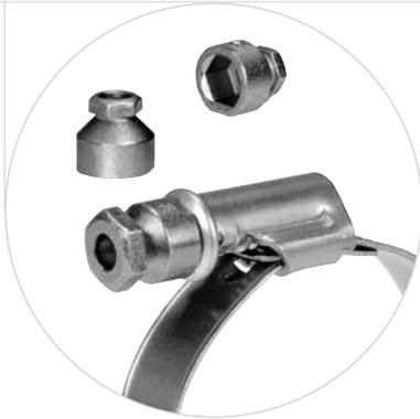
Die Drehmomentkappe schert beim Erreichen des zulässigen Drehmoments ab und erspart somit einen Drehmomentschlüssel. Der Schraubenschlitz ist nach dem Sollbruch wieder zugänglich, so dass die Schelle demontiert und/oder gegebenenfalls nachgespannt werden kann.
