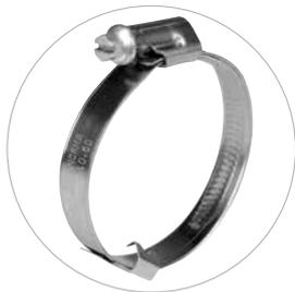
Mit diesem Clip kann die TORRO® auf dem Schlauch vorpositioniert werden. Die beiden 'Zähne' halten die TORRO® Schlauchschelle sicher am Platz, wenn sie vor der Endmontage gelagert oder transportiert werden muss. Auf Anfrage in den Bandbreiten 9 und 12 mm lieferbar.
