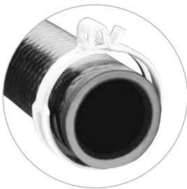
Hierbei handelt es sich um eine vorgeöffnete Schelle, die auf den Schlauch geklebt werden muss. Fragen Sie Ihren Fachhändler nach der Klebeanleitung. Der Haltemechanismus dieser Version ist Teil des Bandes und in die Schelle integriert. Zum Entriegeln vorgeöffneter FBS C ist nur unser Entriegelungswerkzeug zulässig.
