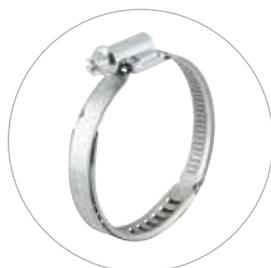
Im Vergleich zu herkömmlichen Schneckengewinde-Schlauchschellen ist der Radialeinsatz eine „Federechelle“, die ein optimales Ausdehnen und Zusammenziehen ermöglicht. Er ist für alle Anwendungen geeignet, bei denen der Schlauch Temperaturschwankungen unterliegt. Die spezielle Konstruktion gewährleistet während des gesamten Temperaturzyklus eine zuverlässige Abdichtung. Für die TORRO® in der Bandbreite 9 mm erhältlich.
