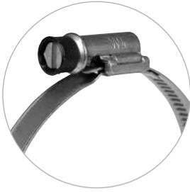
Die NORMACLAMP® TORRO® Abrutschsicherung 9/12 - 1043 0000 364 ist ein Kunststoffring, der leicht auf den Schraubenkopf der Schelle aufgebracht werden kann. Er erleichtert die Montage wesentlich, da ein Abrutschen des Schraubendrehers vom Schraubenkopf nicht möglich ist. Die Abrutschsicherung ist für Schrauben in Schlüsselweite 7 erhältlich.
