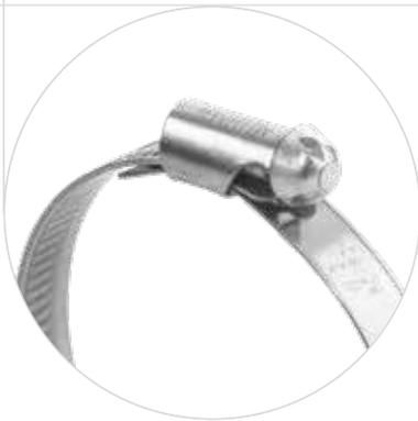
Die NORMACLAMP® TORRO® Manipulationsschutz kann nur mit einem Spezialwerkzeug montiert und demontiert werden – Details auf Seite 199. Der speziell entwickelte Schraubenkopf besitzt drei radiale Nuten, was bedeutet, dass keine handelsüblichen Werkzeuge verwendet werden können. Die automatisierte Montage mit einem Drehmomentschlüssel ist besonders effektiv, da die spezielle Form des Schraubenkopfes nur minimale Fehlansrichtung oder Versatz ermöglicht.
