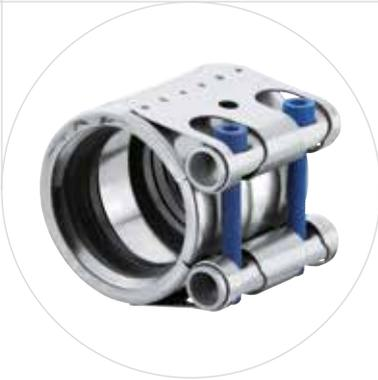
**NORMACONNECT® FLEX E** ist eine axial nicht zugfeste Rohrkupplung. Sie wird zur Verbindung von Metallrohren, Edelstahlrohren sowie Beton- und Kunststoffrohren verwendet. Dies ist eine Variante mit Hohlbolzen.
