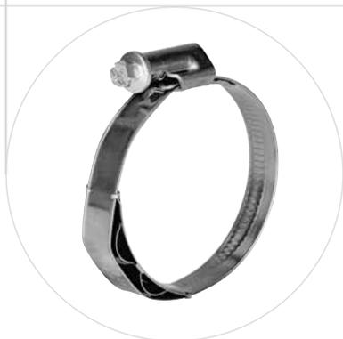
Die TORRO® WF Schelle ist mit einer Wellfeder ausgestattet, die automatisch nachgespannt wird, um eine optimale radiale Spannkraft zu gewährleisten. Die TORRO® WF ist die ideale Wahl für Anwendungen mit extremen Temperaturschwankungen (z.B. Ladeluft), mit extrem niedrigen Temperaturen oder zum Halten von Schläuchen mit „Kriechneigung“/Schlauchentspannung.
